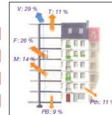
**Illustration 2:** Immeuble mitoyen, non isolé construit en béton 20 cm. Svitrée = 40 % Sfaçade.
